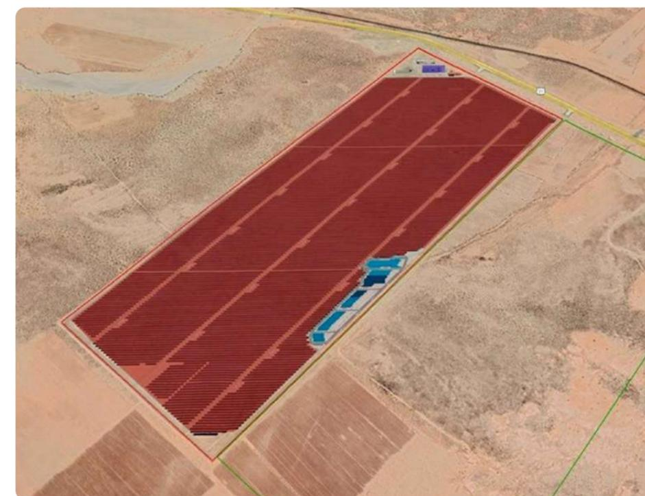
LAY OUT Propuesta sector ampliación Planta Solar Fotovoltaica Uyuni.
